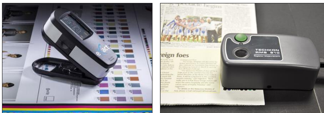
Instrumento de medición colorimétrica "eXact" de X-Rite (izda.) e instrumento de medición del registro "RMS 910" de Techkon (dcha.)
